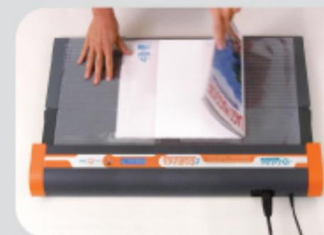
2 Postavite ovitek CoLibri v režo in pritisnite START: e-DaVinci aktivira senzorje, se avtomatsko spusti, odreže in zavari ovitek.
